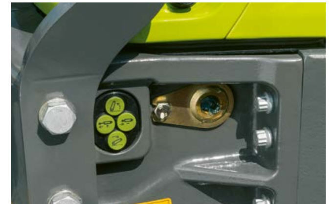
Предният навес и допълнителния хидравличен извод за управление могат да се обслужват и външно чрез клапани с електронно управление.
