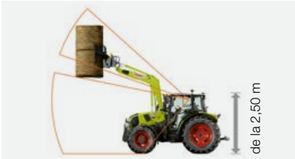
Cabină cu plafon coborât, cu trapă transparentă: înălțime de la 2,50 m.
