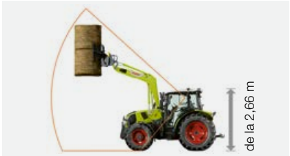
Cabină PANORAMIC cu parbriz și acoperiș din sticlă pentru a asigura o vizibilitate maximă, cu o înălțime de la 2,66 m.
