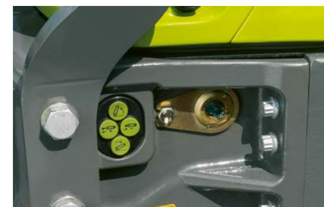
Elektronicky ovládanými rozvaděči může být čelní zvedací závěs a přidavný rozvaděč ovládán také externě.
