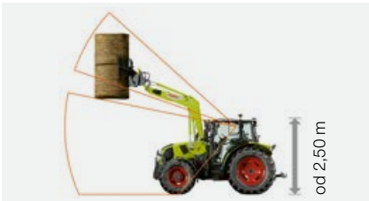
Kabina s nízkou střechou a s proskleným střešním oknem: světlá výška až 2,50 m.
