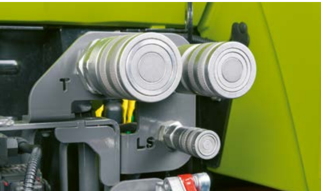
Pro pracovní nářadí s vlastními ovládacími jednotkami se v zadní části pro okruh snímání zatížení Load-Sensing nacházejí přípojky Power-Beyond. Pracovní nářadí si samo řídí svoji potřebu oleje a nedochází tak k permanentní cirkulaci oleje.
