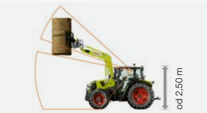
Kabina s nízkou střechou a s proskleným střeším oknem: světlá výška až 2,50 m.
