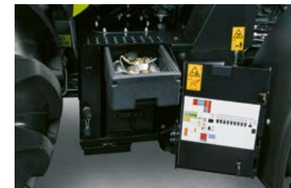
Na pravé straně u nástupních schodků najdete dobře přístupnou baterii, přihrádku na nářadí a přípojku stlačeného vzduchu.
