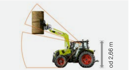
Kabina s vysokou střechou a s proskleným střeším oknem: světlá výška až 2,66 m.
