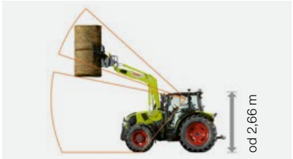
Visoka izvedba kabine s steklenim strešnim oknom: vozna višina od 2,66 m.
