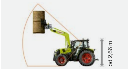
Kabina PANORAMIC z neprekinjenim vetrobranskim steklom do steklene strehe: vozna višina od 2,66 m.
