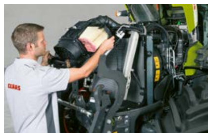
Zračni filter motorja je vgrajen pred ventilatorji, zato je čiščenje enostavno.
