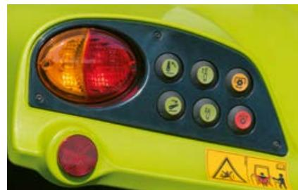
Moguće je upravljanje stražnjom podiznom hidraulikom, elektroničkim upravljačkim uređajem i kardanskim vratilom sa oba bokobrana. Na lijevom boku nalazi se nosač za četiri kugle donje karike.
