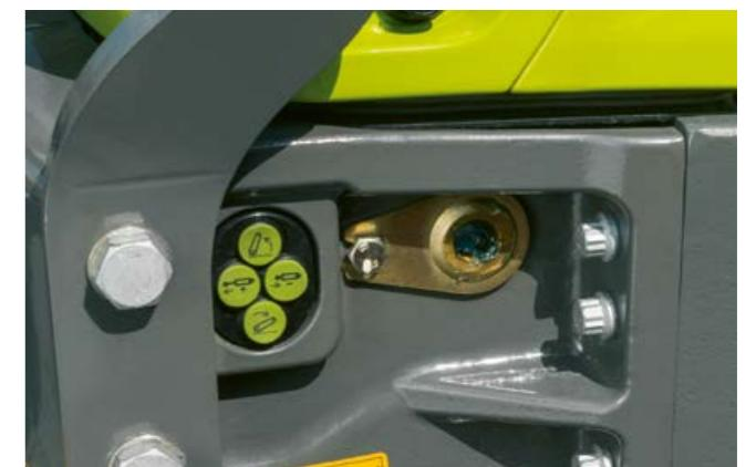
S električnim upravljačkim uređajima, prednjom podiznom hidraulikom i dodatnim upravljačkim uređajem može se upravljati i izvana.
