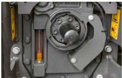
Razinu ulja u mjenjaču i hidrauličkom sustavu možete provjeriti kroz kontrolno staklo pored kardanskog vratila.
