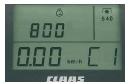
Trenutačni stupanj prijenosa uvijek se prikazuje na nadzornoj ploči. Kod CIS+ i CIS opreme dodatno na A-stupu.
