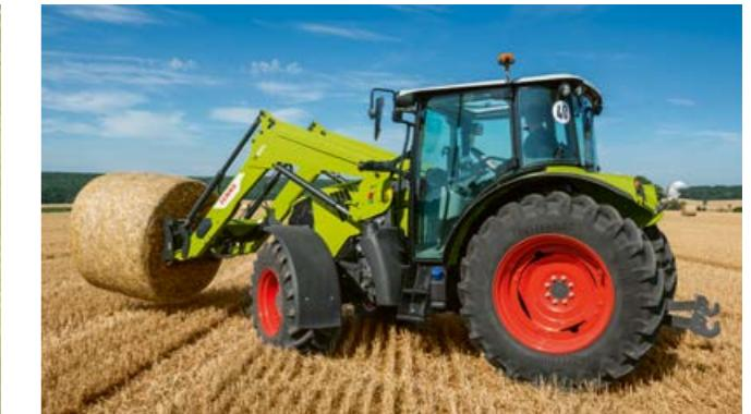
U načinu koji ovisi o kutu volana, omjer prijenosa volana u vožnji ravno naprijed uvelike je smanjen. Okretanje volanom je tada osjetljivije. Što vozač više okreće volan, osovina se više zakreće. Taj način je idealan, na primjer, za rad s prednjim utovarivačem. Vozač može precizno prilagoditi vozilo i brzo manevrirati.
