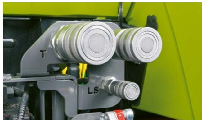
Za dodatne priključne uređaje s vlastitim upravljačkim uređajima, straga se nalaze priključci Power-Beyond za senzorsku hidrauliku osjetljivu na opterećenje. To znači da priključni uređaj kontrolira vlastite potrebe za uljem bez trajne cirkulacije ulja.
