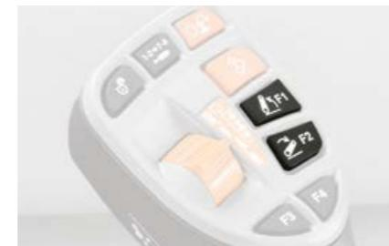
Upravljanje stražnjom podiznom hidraulikom može se obaviti ne samo putem bočne ploče, već i putem višenamjenske ručke.
