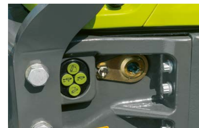
Elektroniczne zawory umożliwiają również zewnętrzną obsługę przedniego podnośnika i dodatkowego zaworu hydraulicznego.
