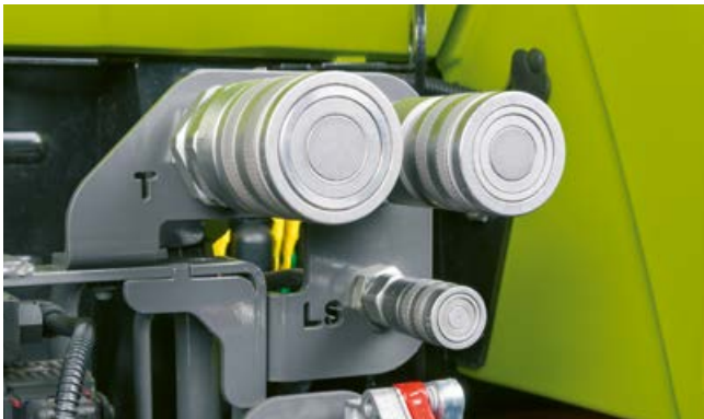
Voor werktuigen met eigen regelventielen zijn voor het loadsensing-systeem aan de achterzijde van de tractor Power-Beyond-aansluitingen aangebracht. Daarmee zorgt het betreffende werktuig voor de eigen behoefte aan olie, zonder permanente circulatie van de olie.
