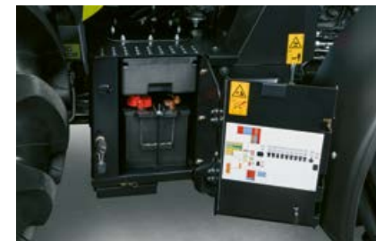
På høyre side av innstigningen finner du batteri, verktøykasse og trykklufttilkobling lett tilgjengelig.
