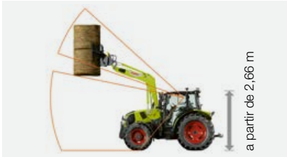
Cabina de techo alto con techo practicable de cristal: Altura de paso a partir de 2,66 m.
