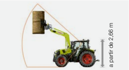
Cabina panorámica con parabrisas delantero continuo hasta el techo de cristal: Altura de paso a partir de 2,66 m.
