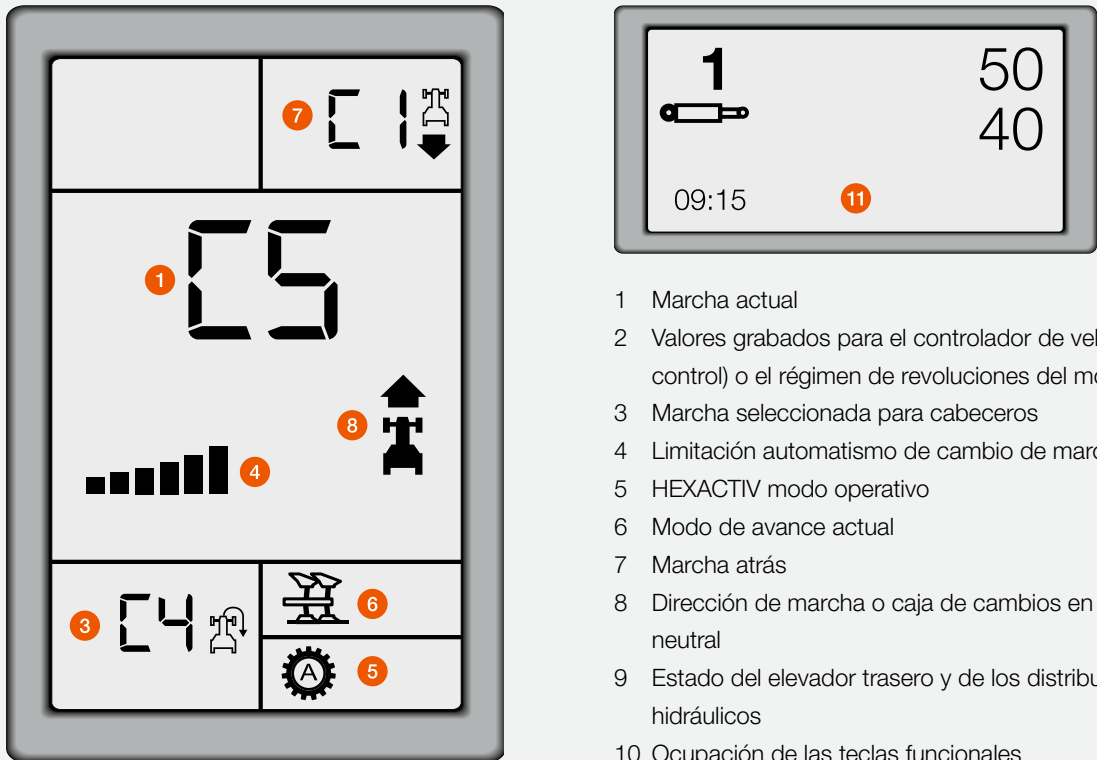
Pantalla CIS en el panel de instrumentos y pantalla de la caja de cambios en el montante A.
