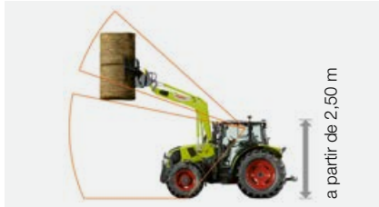
Cabina de techo bajo con techo practicable de cristal: Altura de paso a partir de 2,50 m.
