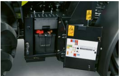
A la derecha del acceso se encuentra, muy a mano, la batería, el espacio para las herramientas y una conexión de aire comprimido.
