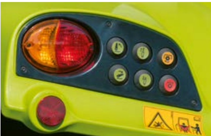
Manejo del elevador trasero, el distribuidor electrohidráulico y la toma de fuerza posible en ambos guardabarros. En el guardabarros izquierdo existe un soporte para cuatro bolas de la barra inferior de tiro.
