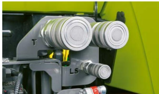
Per attrezzi dotati d'unità di comando proprie gli innesti Power Beyond per il circuito load sensing sono posizionati sulla parte posteriore. L'attrezzo regola così autonomamente la quantità d'olio necessaria, senza che l'olio circoli in permanenza.
