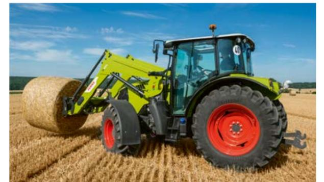
Nella modalità in funzione dell'angolo di sterzo il rapporto di trasmissione durante l'avanzamento in linea retta viene ridotto considerevolmente, consentendo una maggiore sensibilità di sterzata. Lo sterzo reagisce sempre più velocemente via via che l'operatore gira il volante. Questa modalità è indicata, ad esempio, per lavorare con il caricatore frontale, perché l'operatore può manovrare con una maggiore sensibilità e rapidità.
