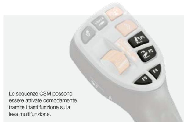
Le sequenze CSM possono essere attivate comodamente tramite i tasti funzione sulla leva multifunzione.
