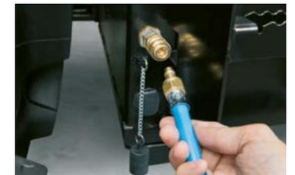
La batteria, il vano portattrezzi e un attacco per l'aria compressa sono posizionati a destra della scaletta d'accesso alla cabina.
