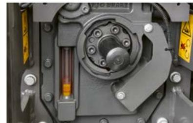
Attraverso un vetro spia posizionato vicino alla presa di forza potete controllare il livello dell'olio idraulico e della trasmissione.
