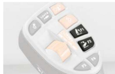
Il sollevatore posteriore può essere comandato sia tramite i tasti di comando sulla console laterale, sia tramite la leva multifunzione.
