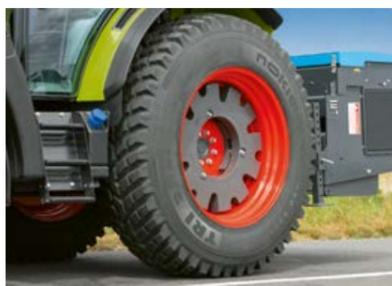
Potete montare zavorre con un peso massimo di 270 kg sulla ruota posteriore sinistra per compensare il peso del braccio caricatore. Una garanzia di stabilità e sicurezza.
