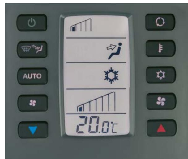
Oltre al climatizzatore manuale, è disponibile anche un climatizzatore automatico, che assicura una diffusione ottimale dell'aria nella cabina.
