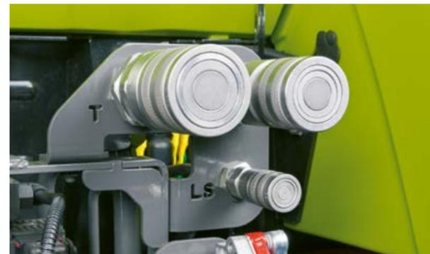
Für Anbaugeräte mit eigenen Steuereinheiten gibt es für den Load-Sensing-Kreislauf die Power-Beyond-Anschlüsse im Heck. Damit steuert das Anbaugerät seinen Ölbedarf selbst, ohne permanenten Ölumlaufl.
