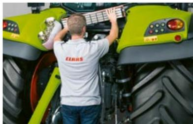
Einfache Erreichbarkeit des Kabinenluftfilters hinter der Kabine.
