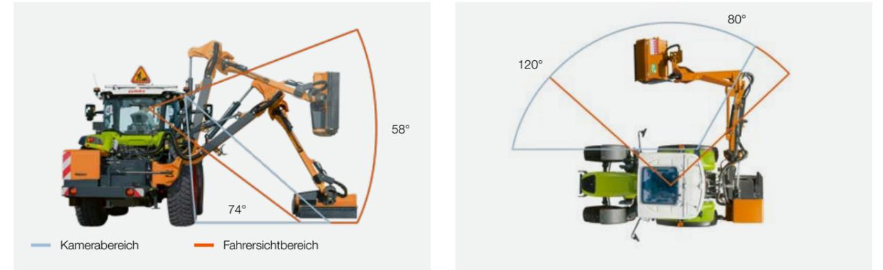
Die großzügige Sicht, die die rechte Seitenscheibe auf den Arbeitsbereich gestattet, wird durch eine Kamera ergänzt. Sie ist geschützt an der rechten Seite des Kabinendachs angebracht. Die Kamera schließt den toten Winkel und hilft Ihnen, Hindernisse und Entfernungen besser einzuschätzen.
