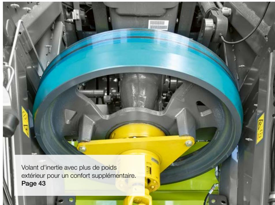
Volant d'inertie avec plus de poids extérieur pour un confort supplémentaire.
