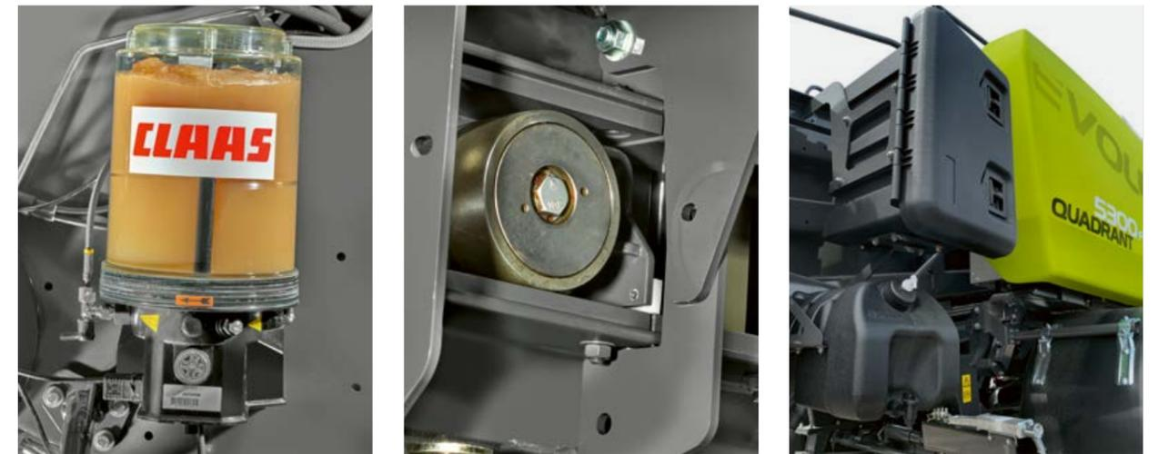
Moins d'entretien grâce au graissage centralisé.
