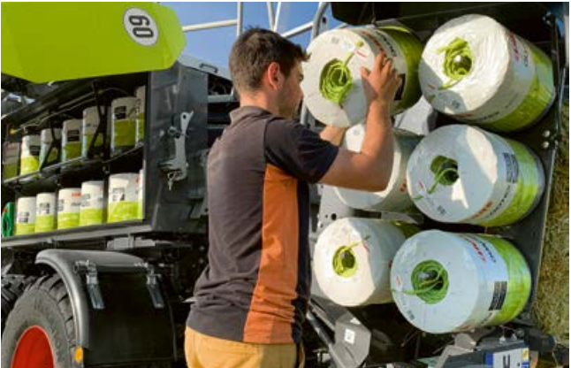
Opcjonalnie: miejsce na 12 dodatkowych rolek sznurka. Taka ilość wystarcza na 350–400 sprasowanych balotów, zależnie od wielkości rolki.
