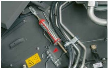
Toate punctele de lubrifiere sunt grupate în bare centrale de lubrifiere și sunt marcate în mod clar.
