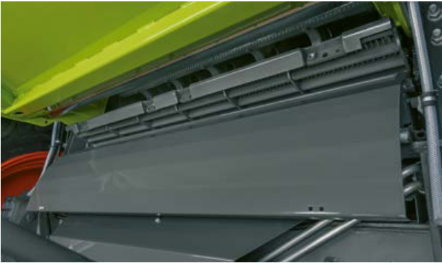
Segmentul contrabătătorului poate fi scos cu ușurință prin trapa de colectare a pietrelor.
