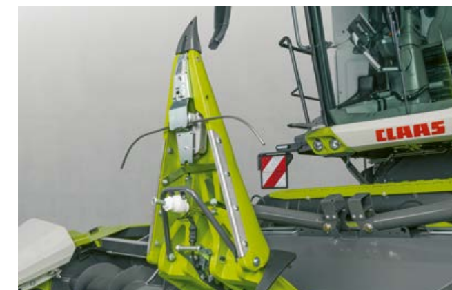
Două benzi de senzori scanează câte un rând de porumb.
