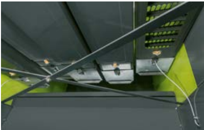
Orificiile de întreținere de la capătul scuturătorilor vă oferă acces rapid, fără scule.
