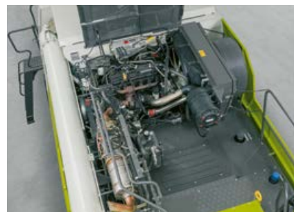
Motor Cummins cu post-tratarea gazelor de eșapament cu AdBlue (Stage V).
