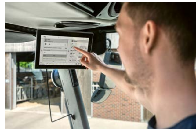
Z CEMIS 1200 można tworzyć wszystkie zlecenia i zarządzać nimi bezpośrednio na maszynie.
