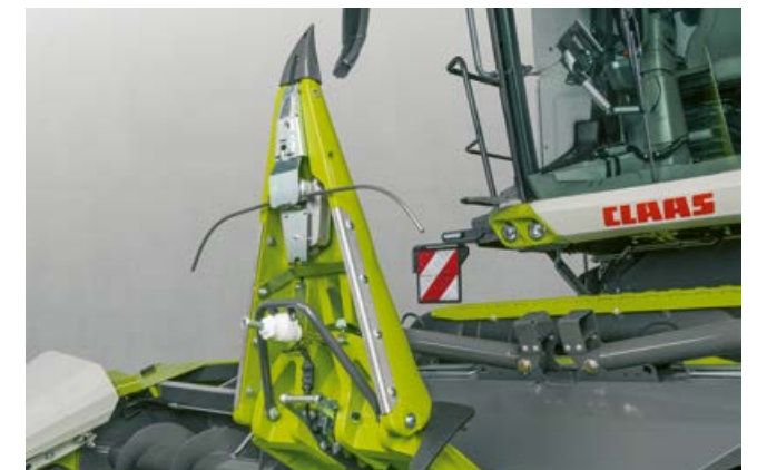
Dwa paląki kopiujące sondują każdy rząd kukurydzy.
