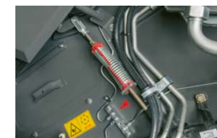
Wszystkie punkty smarowania zebrano w centralnej listwy smarowników i wyraźnie oznakowano.
