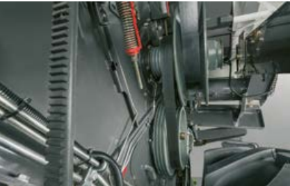
Napęd bębna młóścącego z dwoma łatwo ustawianymi zakresami prędkości obrotowej.
