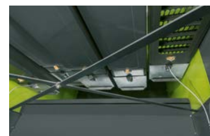
Otwory konserwacyjne na końcu wytrąsacza zapewniają szybki dostęp bez użycia narzędzi.
