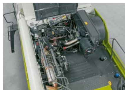
Cummins motor s AdBlue naknadnom obradom ispušnih plinova (Stage V)
