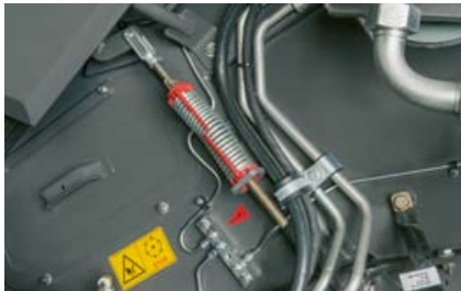
Sva mjesta za podmazivanje grupirana su u središnje trake za podmazivanje i jasno označena.
