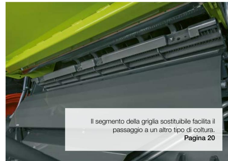
Il segmento della griglia sostituibile facilita il passaggio a un altro tipo di coltura.
