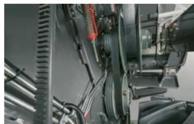
Trasmissione del battitore con due gamme di velocità facilmente regolabili.
