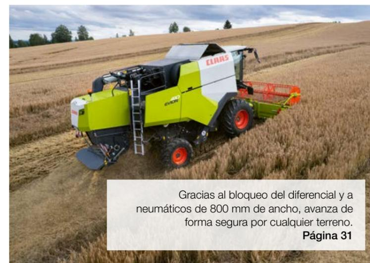
Gracias al bloqueo del diferencial y a neumáticos de 800 mm de ancho, avanza de forma segura por cualquier terreno.
