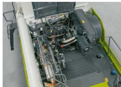
Motor Cummins con tratamiento posterior de los gases de escape con AdBlue (Stage V)
