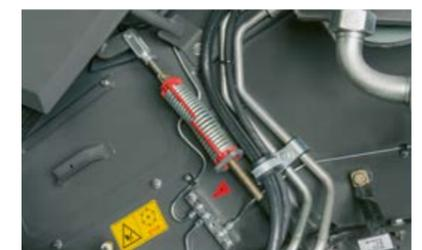
Todos los puntos de lubricación están recopilados en barras centrales de lubricación y tienen una señalización clara.
