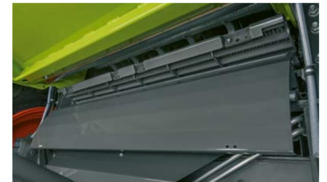
El segmento del cóncavo se puede sacar fácilmente por el dispositivo recogedor de piedras.
