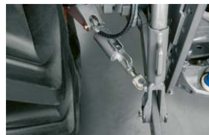
Az opcionális hidraulikus oldalsó stabilizátorok nagyobb biztonságot nyújtanak és megkönnyítik a munkát.
