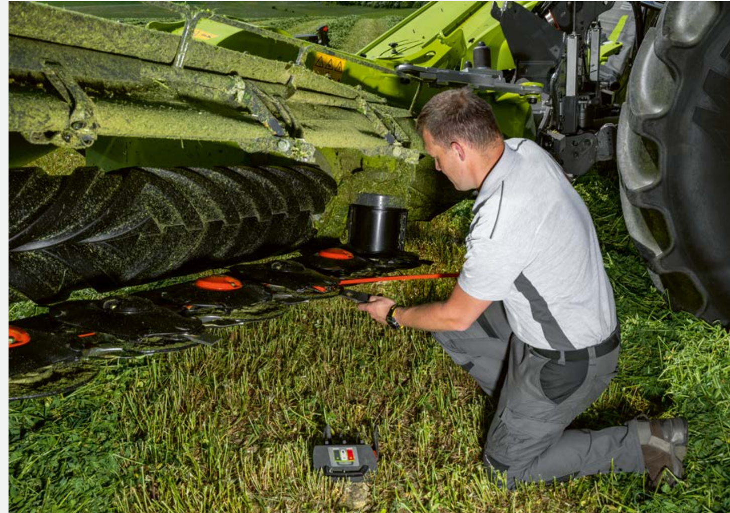
A csere pengéket a kasza esőálló dobozában tárolják, így közvetlenül a munkavégzés helyén gond nélkül cserélhetők. A kések gyorsan és egyszerűen cserélhetők a kaszába integrált szerelőkar segítségével.
