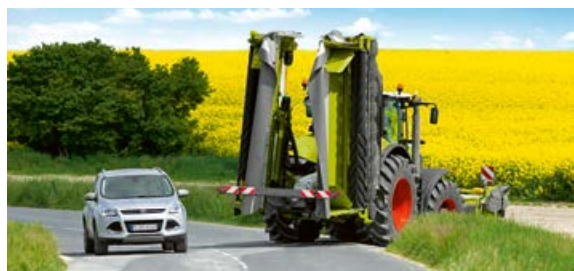
Kevesebb mint 4 méter: kompakt szállítási helyzet bőséges hasmagassággal mindkét BUSINESS modellben.
