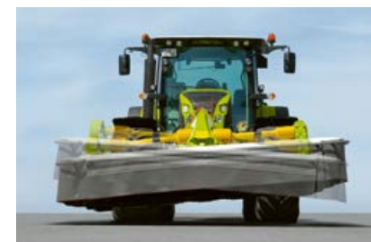
Vabalt liikuv pendelriputus, mis võimaldab järgida maapinda sõidusuunaga risti.
