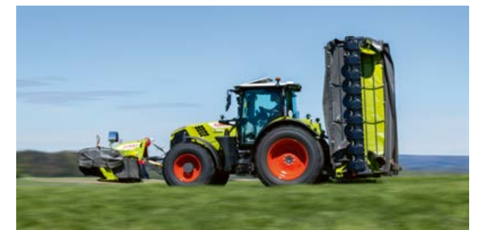
Alla 4 m: kompaktne transpordiasend ohutuks maanteeõiduks.
