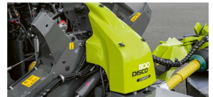
Kompaktne ja stabiilne kinnituspukk, millesse on standardvarustusena integreeritud ACTIVE FLOATi vedrustussüsteem.
