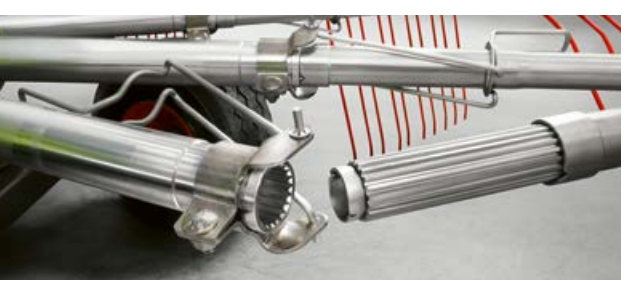
Kényelmes a kar rögzítése és eltávolítása: a szabadalmaztatott PROFIX rögzítőrendszer bordázott tengellyel.
