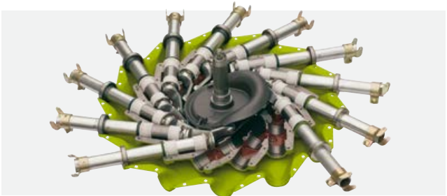
Karbantartásmentes megbízhatóság: a LINER központi eleme az olajfürdőben futó vezérlőpálya.
