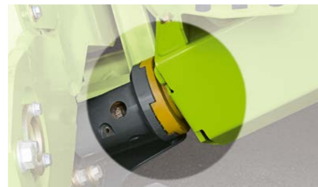
Erőátvitel gyorscsatlakozón keresztül
