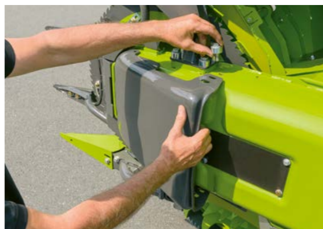
A csúszótalpak magassága kétfokozatban állítható
