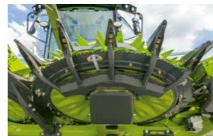
Robusztus terelőujjak és tisztítók a késtárcsa alatt a tiszta munkavégzés érdekében
