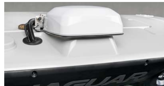
Antenă și receptor SAT 900 într-o singură unitate – cu protecție antifurt
