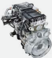
Tehnologie Turbo-Compound pentru OM 471 LA
