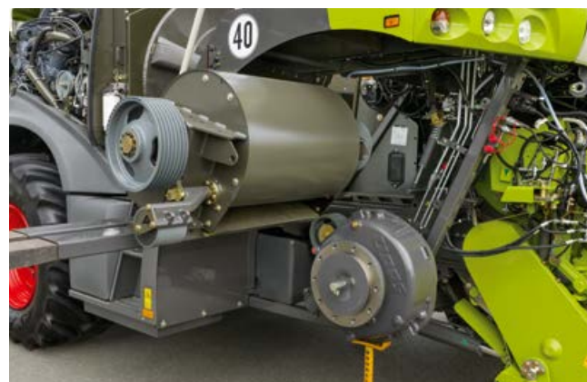
Îndepărtare și montare ușoară a acceleratorului
