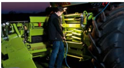
QUICK ACCESS vă permite să inspectați mecanismul de tocare în doar câteva minute.
