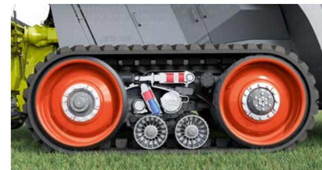
Suprafață de contact de 100%: rola de șenilă ia contact cu solul.
