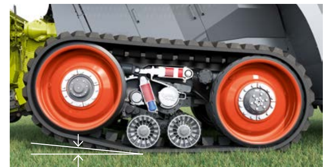
Suprafață de contact de 66%: rola de șenilă este ridicată în viraje.
