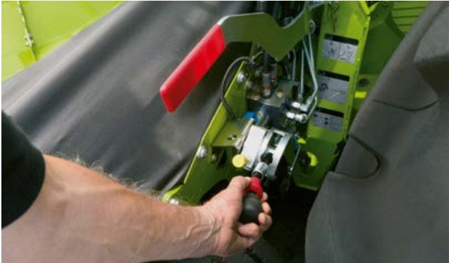
การปรับความเร็วสามขั้นตอนของลูกกลิ้งป้อนสำหรับการไหลของวัสดุที่ดีที่สุด
