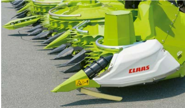
หากจำเป็น การขับเคลื่อนเกลียวลำเลียงสำหรับข้าวโพดล้มจะเป็นแบบไฮดรอลิก
