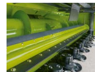
DIRECT DISC 600 P / 500 P พร้อม ลูกกลิ้งพายที่ปรับความสูงได้ สามารถ เลือกใช้งานแบบไฮดรอลิกได้
