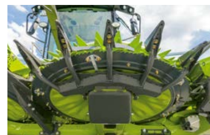
นิ้วกดและตัวปล่อยพืชที่ทนทานได้งานดีสำหรับการทำงานที่สะอาด
