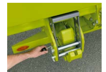
เมื่ออุปกรณ์ด้านหน้าถูกล็อคเข้าที่ สามารถเดินทางได้อย่างปลอดภัยที่ ความเร็วสูงสุด 40 กม./ชม
