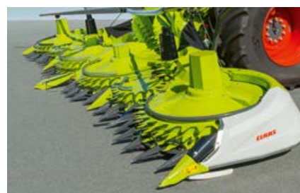
การออกแบบที่แบนมากสำหรับช่วงพืชที่เตี้ย
