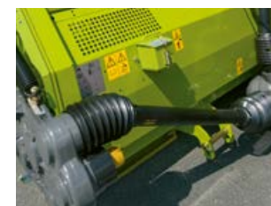
ชุดขับเคลื่อนกำลังสูงพร้อมเกียร์สาม ระดับ
