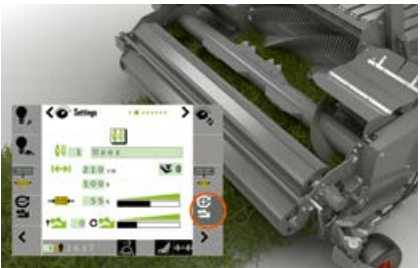
POWER FEEDING SYSTEM легко переключается в режим реверса из кабины механизатора.
