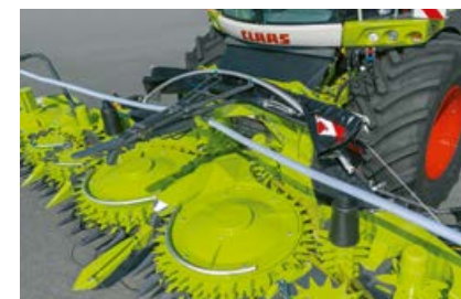
Kompakts izvietojums, ražas novākšanas laikā neaizsedz skatu uz ORBIS. Transporta aizsardzība tiek atstāta uz mašīnas.
