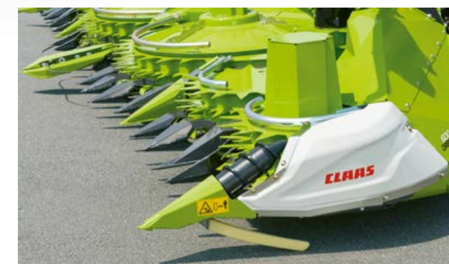
Ja kukurūza ir veldrē, padeves šņekus darbina hidrauliski.
