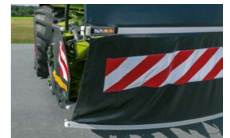
Sānu un priekšas aizsardzība tiek skaidri parādīta ar brīdinājuma uzlīmēm. LED apgaismojums ir pilnībā integrēts.
