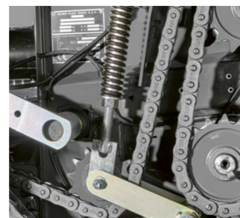
Эффективное устройство для натяжения цепи.
