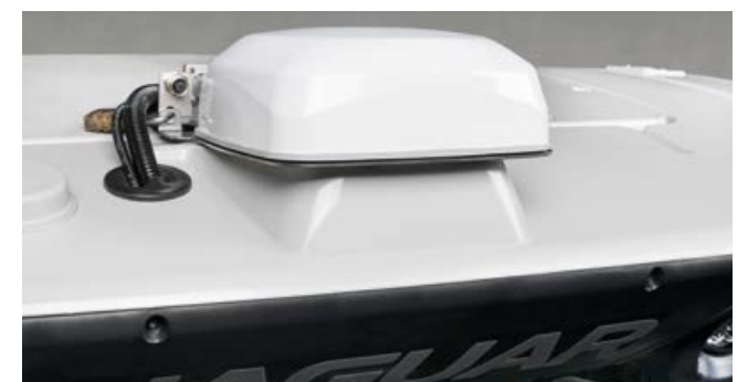
SAT 900 antena un uztvērējs vienā blokā – ar aizsardzību pret zādzību
