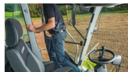
Sēdekļa kontaktslēdzis automātiski izslēdz darba hederu un galveno piedziņu.
