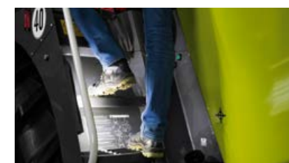
LED kāpšļu apgaismojums drošai iekāpšanai un izkāpšanai.
