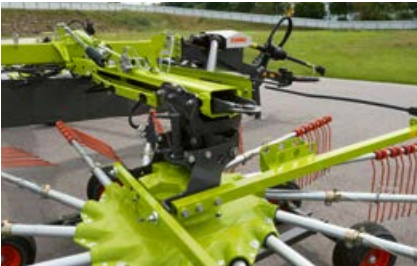
Nastavení výšky konce prstů nad terénem při shrnování. Tato funkce je možná volitelně i hydraulicky. Strana se volí tahem lana.
