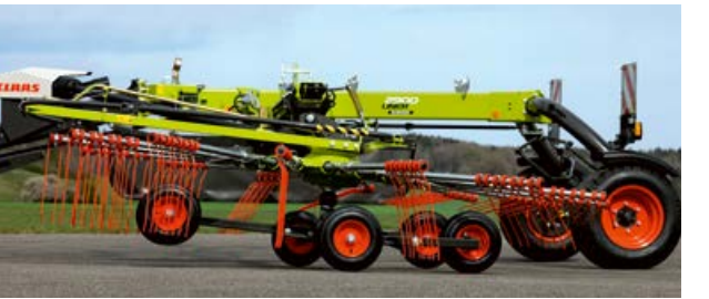
JET-efekt: Rotor se při zvedání resp. spouštění chová jako letadlo při startu resp. přistání.
