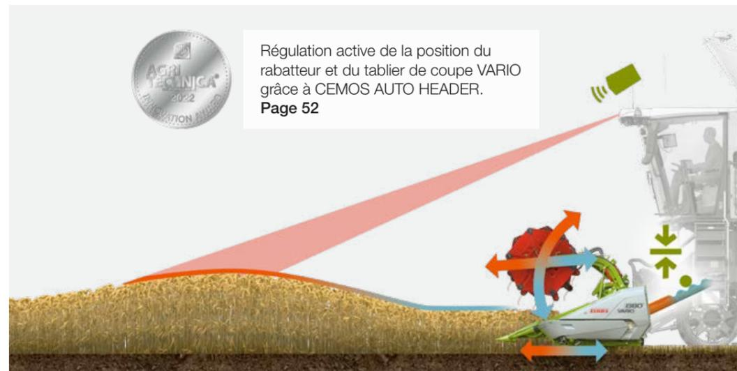
Régulation active de la position du rabatteur et du tablier de coupe VARIO grâce à CEMOS AUTO HEADER.
