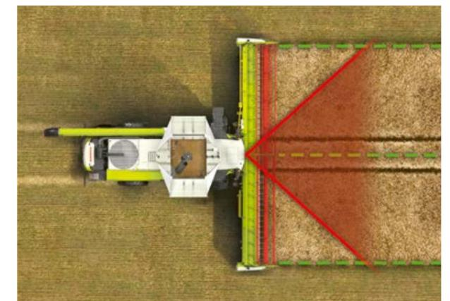
LASER PILOT avec FIELD SCANNER
