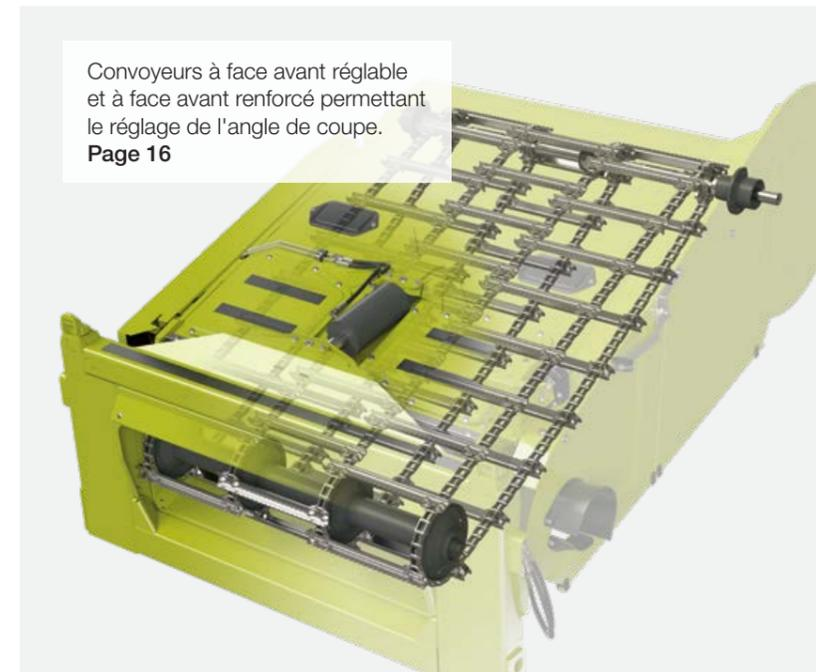
Convoyeurs à face avant réglable et à face avant renforcé permettant le réglage de l'angle de coupe.
