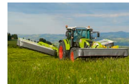
Díky kompaktnímu zavěšení v předních ramenech disponuje žací stroj na souvrati velkou světlostou výškou.
