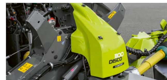
Kompaktní a stabilní konstrukce se sériově integrovaným systémem odlehčení ACTIVE FLOAT.
