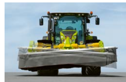
Přizpůsobení příčně ke směru jízdy díky volně se pohybujícímu zavěšení.
