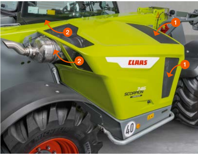
▲ Повітря всмоктується спереду в чистій зоні (1) й відводиться вгору в задній частині (2). Це не лякає тварин і водночас зменшує утворення пилу.
