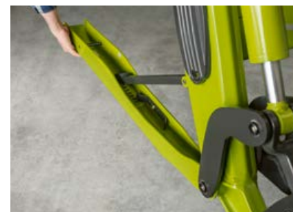
Seisontatuet nostetaan aisastoa vasten eivätkä ne haittaa näkyvyyttä työvarusteelle.
