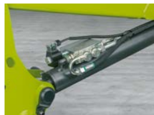
Mallisarjojen FL ja FL C sähköisen vaihdon ansiosta voidaan varoventtiili yhdistää SHOCK ELIMINATOR heiluntavaimennuksen kanssa.
