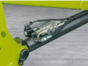
Graças à comutação elétrica nas séries FL e FL C, as válvulas de segurança podem ser combinadas com o amortecimento de oscilações SHOCK ELIMINATOR.
