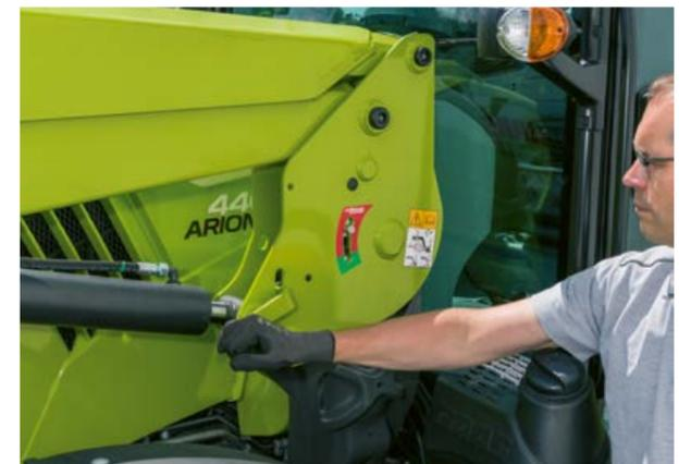
Dank der Verriegelungsanzeige sehen Sie von der Kabine aus genau, wenn die Schwinge des Frontladers eingerastet ist. Das Abkuppeln ist genauso schnell und einfach erledigt.
