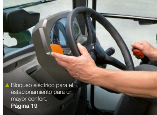
▲ Bloqueo eléctrico para el estacionamiento para un mayor confort.
