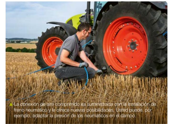
▲ La conexión de aire comprimido es suministrada con la instalación de freno neumático y le ofrece nuevas posibilidades. Usted puede, por ejemplo, adaptar la presión de los neumáticos en el campo.
