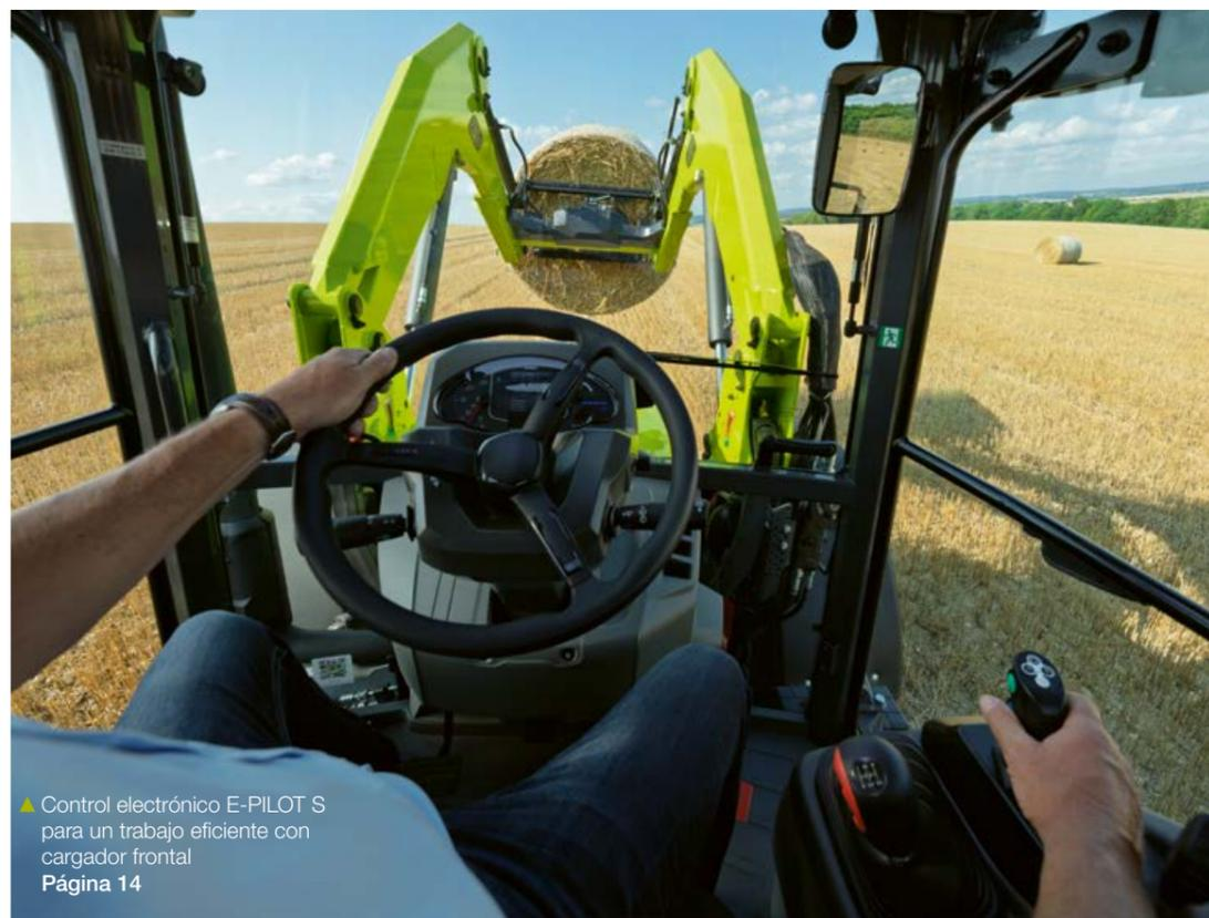
▲ Control electrónico E-PILOT S para un trabajo eficiente con cargador frontal
