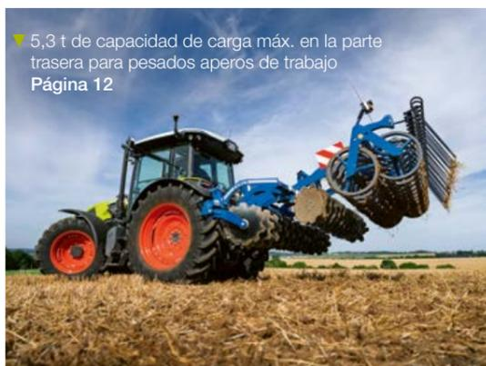
▼ 5,3 t de capacidad de carga máx. en la parte trasera para pesados aperos de trabajo
