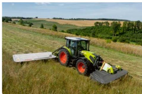
◀ Hasta 120 CV de potencia de motor, elevador delantero y toma de fuerza: Con una combinación de segadora frontal y trasera DISCO, el AXOS es capaz de segar más de 6 metros de hierba en un solo paso.
