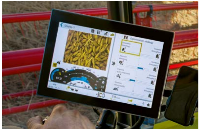
Intelligente Steuerung durch CEMOS AUTOMATIC über CEBIS
