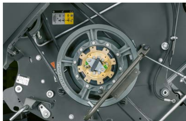
Hitrost vrtljajev rezalnika slame je mogoče uporabiti prilagoditi enostavno, hitro in brez uporabe orodja.
