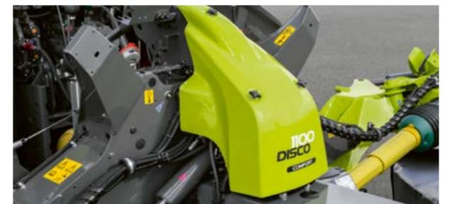
Tête d'attelage compacte et robuste dotée de série de la suspension ACTIVE FLOAT
