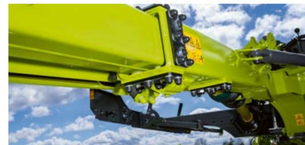
Deux bras télescopiques à commande hydraulique réglables en continu pour un chevauchement optimal sur la DISCO 1100 COMFORT
