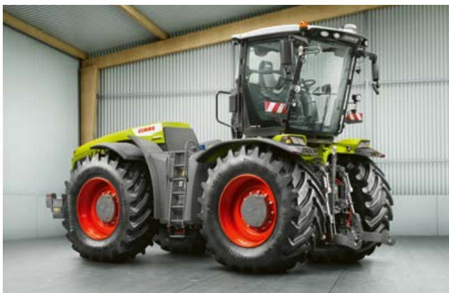
Le XERION TRAC VC dispose du dispositif à poste inversé le plus confortable du marché. Sa cabine peut pivoter à 180° en moins de 30 secondes.
