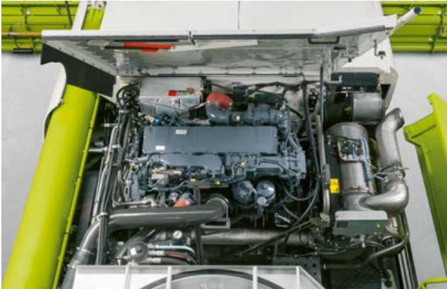
LEXION 6900 avec moteur MAN D26 de 373 kW / 507 ch
