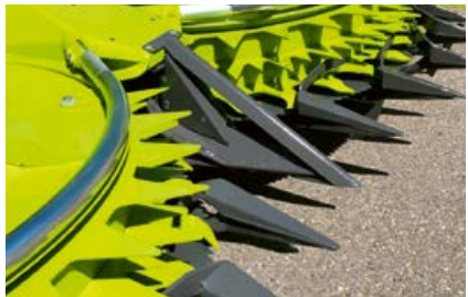
Coupe propre des chaumes avec la pointe centrale fine.
