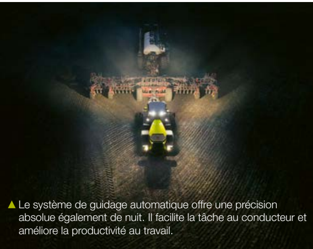
▲ Travail du sol avec l'AXION 800. Équipement numérique : GPS PILOT CEMIS 1200 en mode A-B-Contour et CEMOS.
