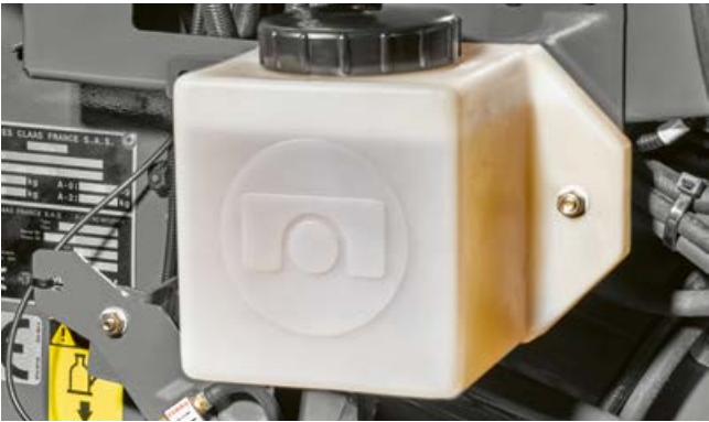
Lubrification permanente des chaînes.
