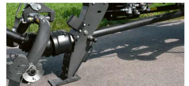
Béquille semi-automatique. Tous les andaineurs LINER à 4 rotors sont dotés d'une béquille semi-automatique de conception intelligente qui peut être actionnée confortablement d'une seule main.
