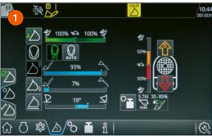
La limitation de la hauteur de levage et d'abaissement enregistre la position près du sol et la hauteur de bennage idéales.
