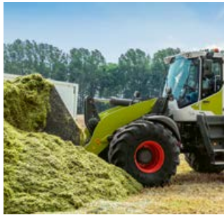
La vitesse de déversement réduite préserve les composants du mât.
